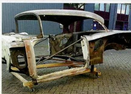
Sander entschied sich die Komplettrestauration mit dem Einbau eines LT4-V8 zu kombinieren.
