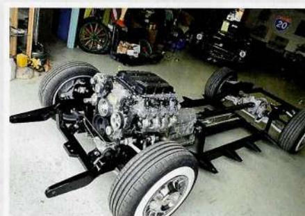
Um den Einbau des LT4 zu ermöglichen, fertigte Sander ein komplett neues Chassis.
